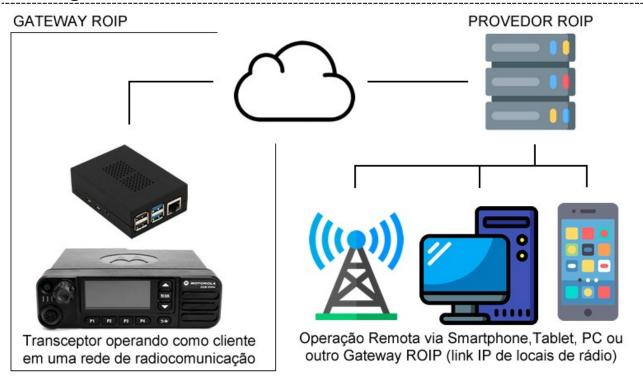
No local dentro da área de cobertura de radiocomunicação, deverá ser instalado um gateway de radiocomunicação composto por um equipamento transceptor (estação base dedicada) conectado ao equipamento GATEWAY ROIP qual conecta-se via internet com o provedor ROIP. O provedor ROIP (Radio-Over-IP) poderá receber conexões para operação de outros Gateways ROIP (para link de localidades via IP) ou Smartphones, Tablets e Computadores para OPERAÇÃO REMOTA pelo aplicativo.
